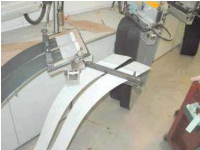
Bild5: Riemen für das Verschweißen vorbereitet (Bild Reichenbach GmbH)
